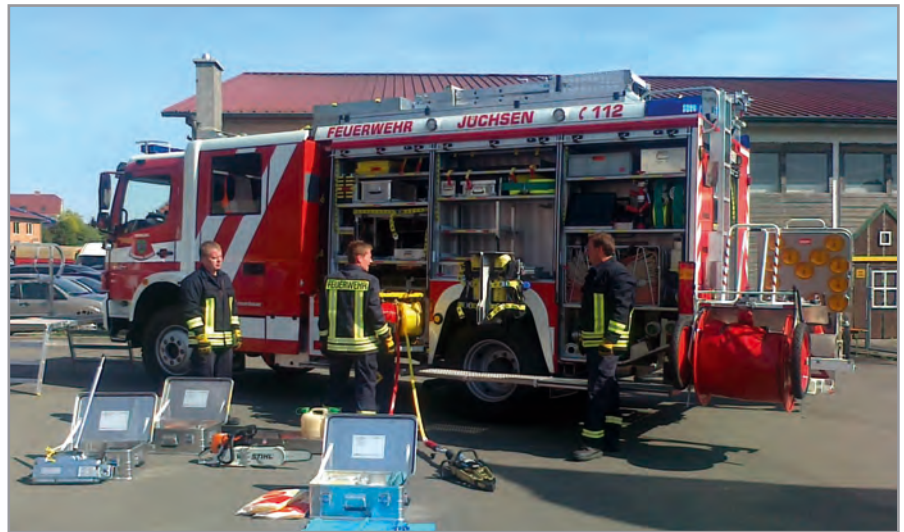
Das neue Hilfeleistungslöschfahrzeug 20/16 wurde zum Sommerfest der Jüchsener Feuerwehr geweiht und offiziell übergeben. Es verfügt über einen Löschwasservorrat von 1600 Litern, 200 Liter Schaummittel, eine Schaummischanlage, 4 Pressluftatmer, Notstromaggregat und Lichtmast. Foto: FF Jüchsen
