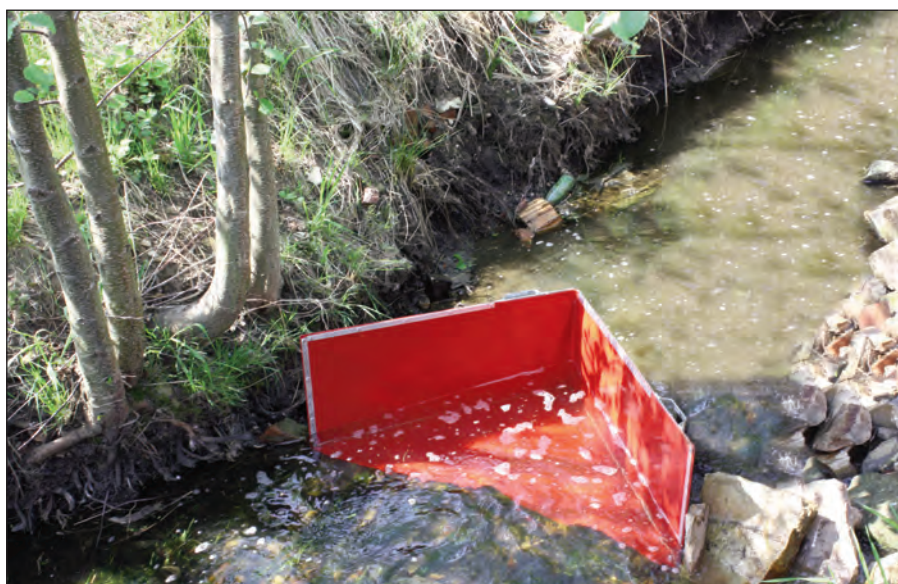
Die mobile Staustufe „Biber“ ist einfach zu handhaben, schnell aufgebaut und einsatzbereit.
