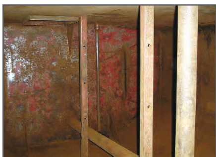
Das Herzstück des Tatra 815 - der Tank von innen. Erst total verrostet, dann grundiert und schließlich für kommende Jahre lackiert.
