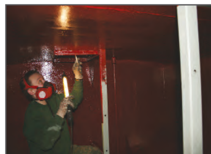
Das Herzstück des Tatra 815 - der Tank von innen. Erst total verrostet, dann grundiert und schließlich für kommende Jahre lackiert.
