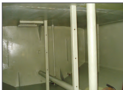
Das Herzstück des Tatra 815 - der Tank von innen. Erst total verrostet, dann grundiert und schließlich für kommende Jahre lackiert.
